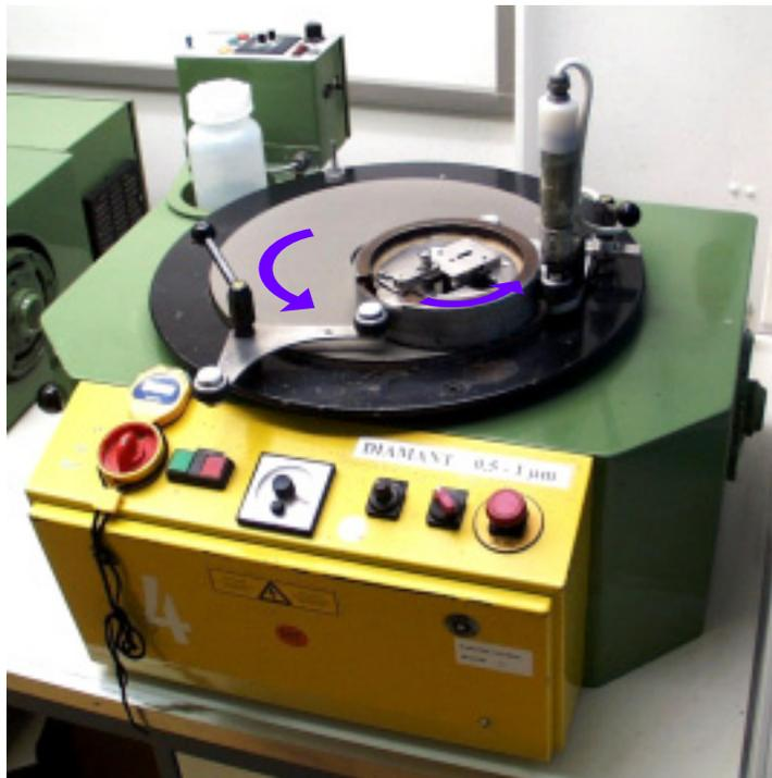
Maschine zum Nanoschleifen
